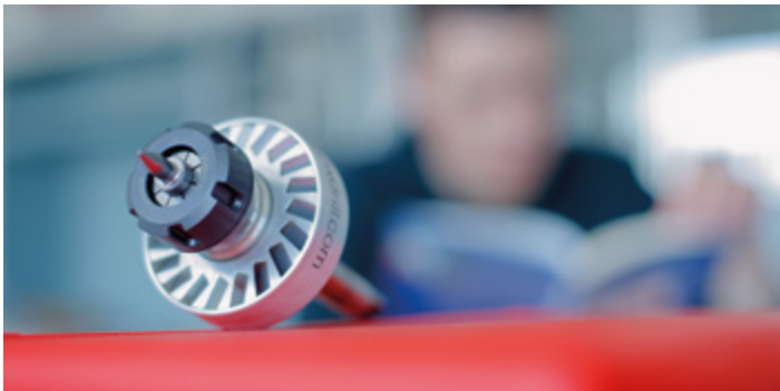
Arbeiten mit dem Fliesslöcherbohrer.
